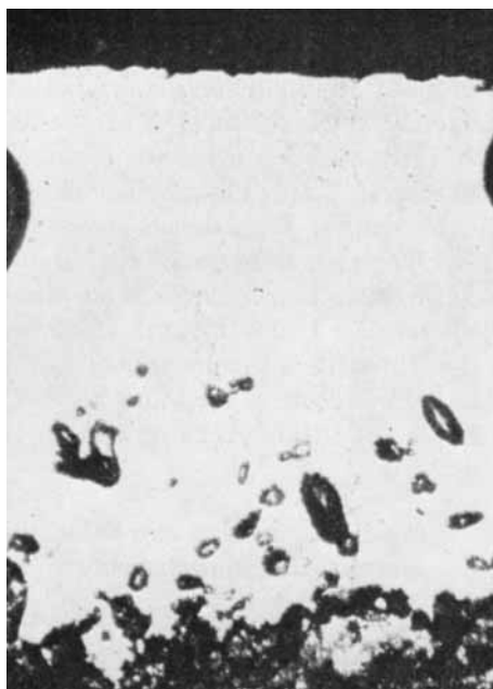
Bild 11. Prüfspalt nach der Vernetzung. Aushärtetemperatur, 170°C.
